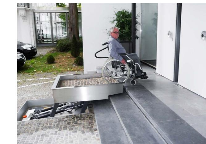
Die Bedienung erfolgt mit einer auf der Plattform installierten Bediensäule oder mit einer Funkfernbedienung. Die Gestaltung des Liftes kann der Umgebung angepasst werden, indem Bodenbeläge auf der Plattform übernommen werden. Die Fertigung des Hydroliftes ist auftragsbezogen und daher für jeden Einsatzzweck individuell.
